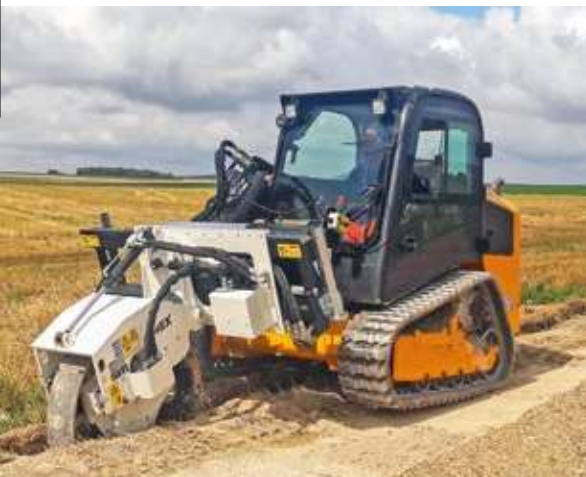
CT 2.8 F.O. Compactage hors gabarit d'une fouille à section prédéfinie après la pose des services accessoires.
